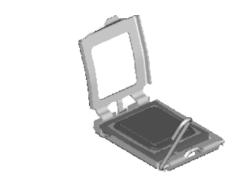
2. 寻找 CPU 上的两个定位口,使定位口与CPU插槽的两个定位口——对应并且方向正确, CPU才能轻松放入。
